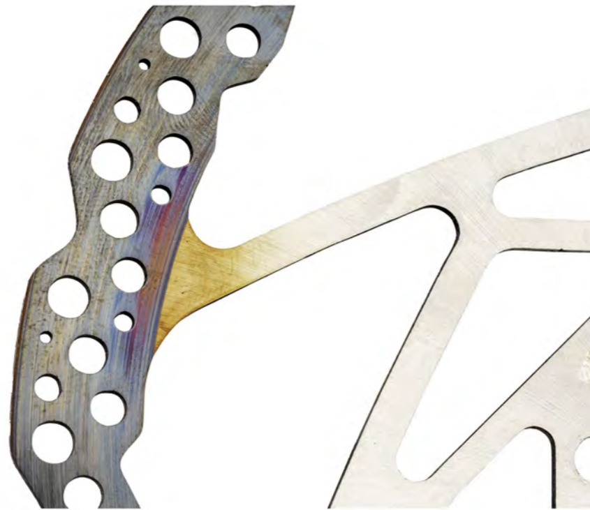
Grössere Scheibe wird benötigt
